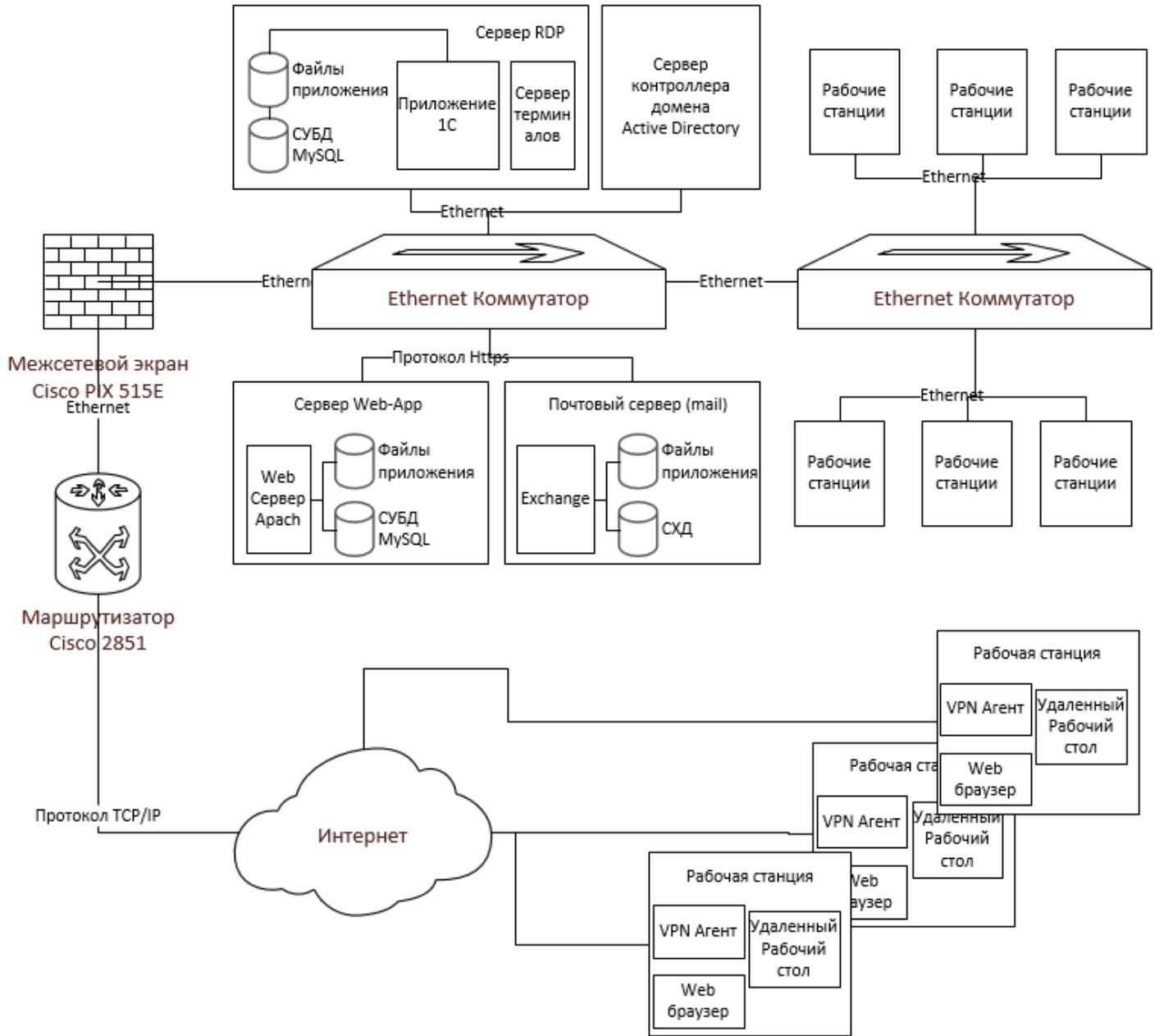
Рисунок 8. Программная архитектура системы защищенного доступа к локальной сети
