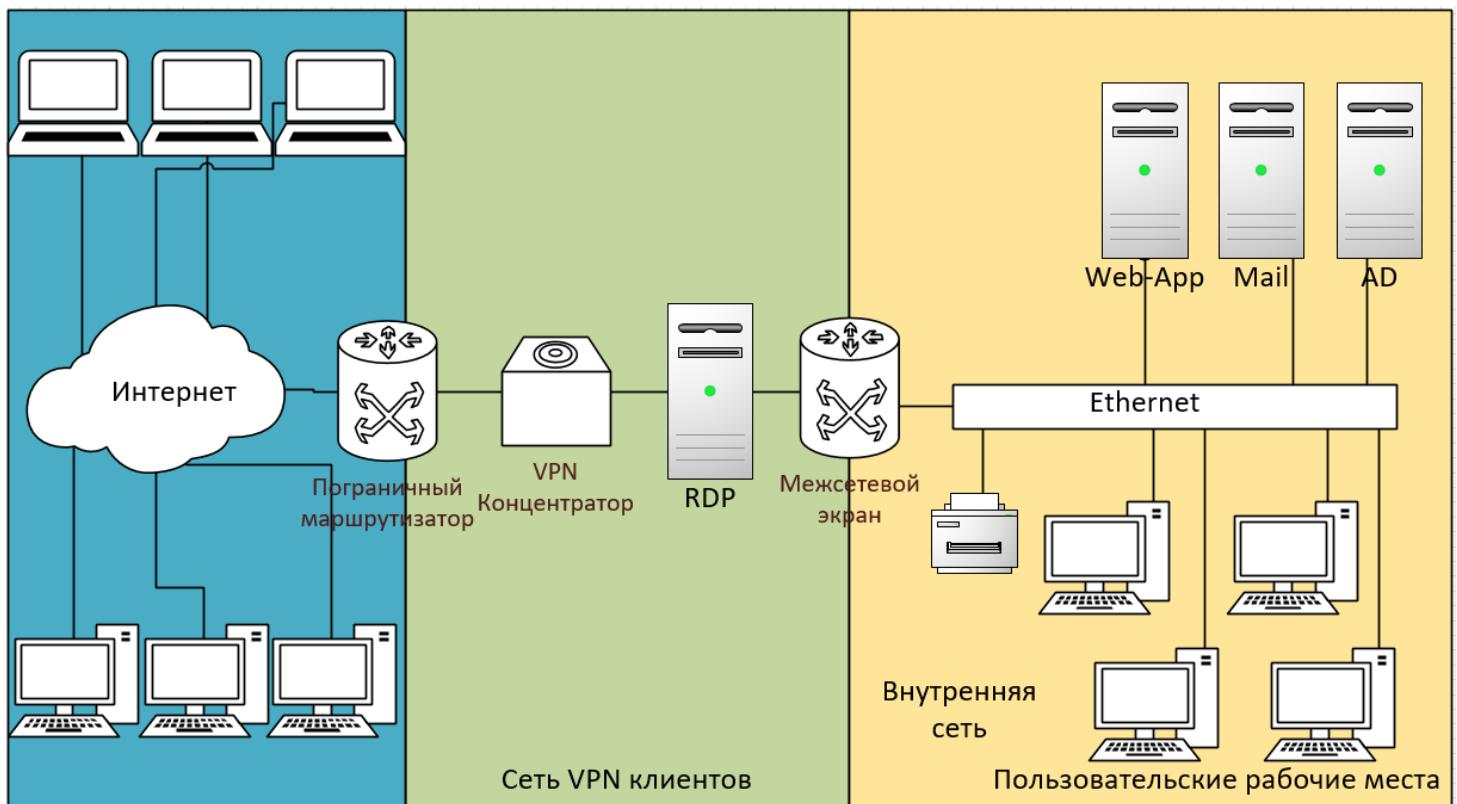
**Рисунок 6. Схема удаленного доступа к локальной сети из интернета по варианту «Создание защищённого доступа в локальную сеть посредством VPN»**
