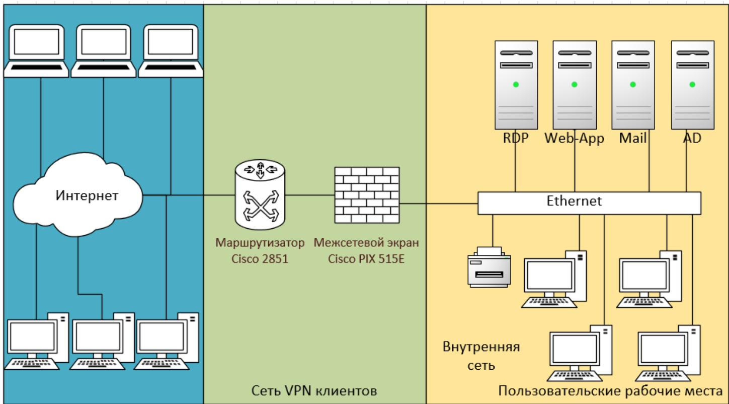
Рисунок 7. Схема удаленного доступа к локальной сети с использованием технологии «VPN»
