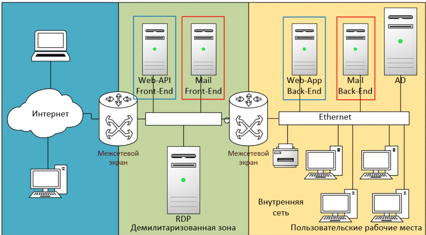
**Рисунок 5. Схема удаленного доступа к локальной сети из интернета по варианту «Разделение сервисов на Front-End и Back-End»**
