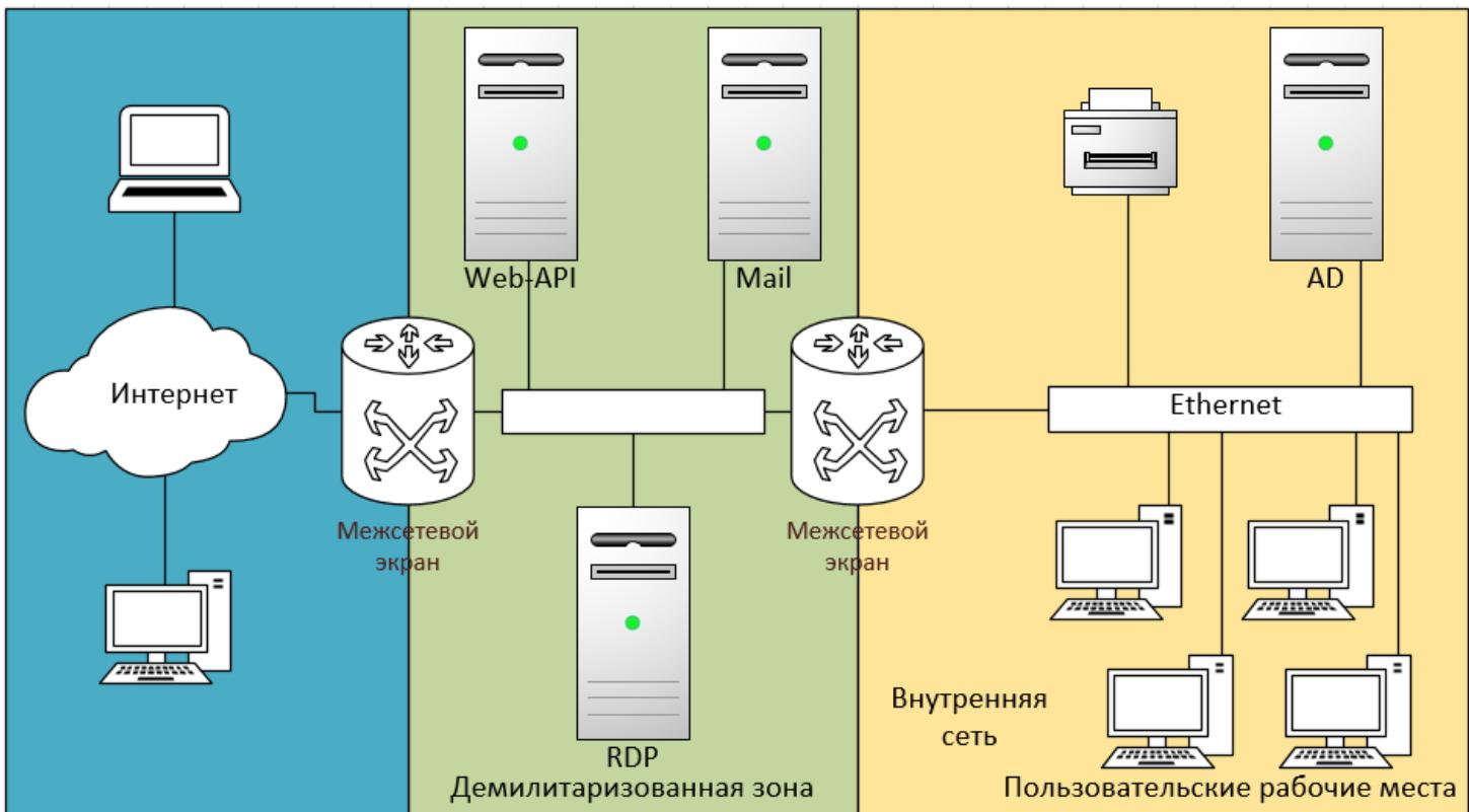
**Рисунок 3. Схема удаленного доступа к локальной сети из интернета по варианту «Создание демилитаризованной зоны»**
