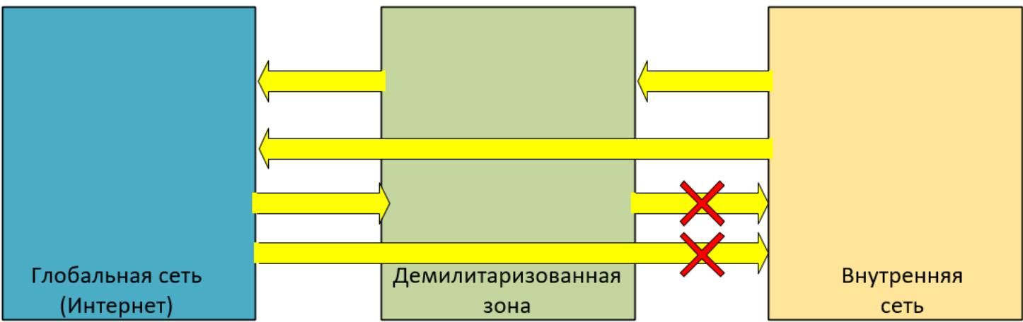
**Рисунок 4. Правила конфигурировать фильтрации пакетов на сетевых экранах при реализации варианта «Создание демилитаризованной зоны»**
