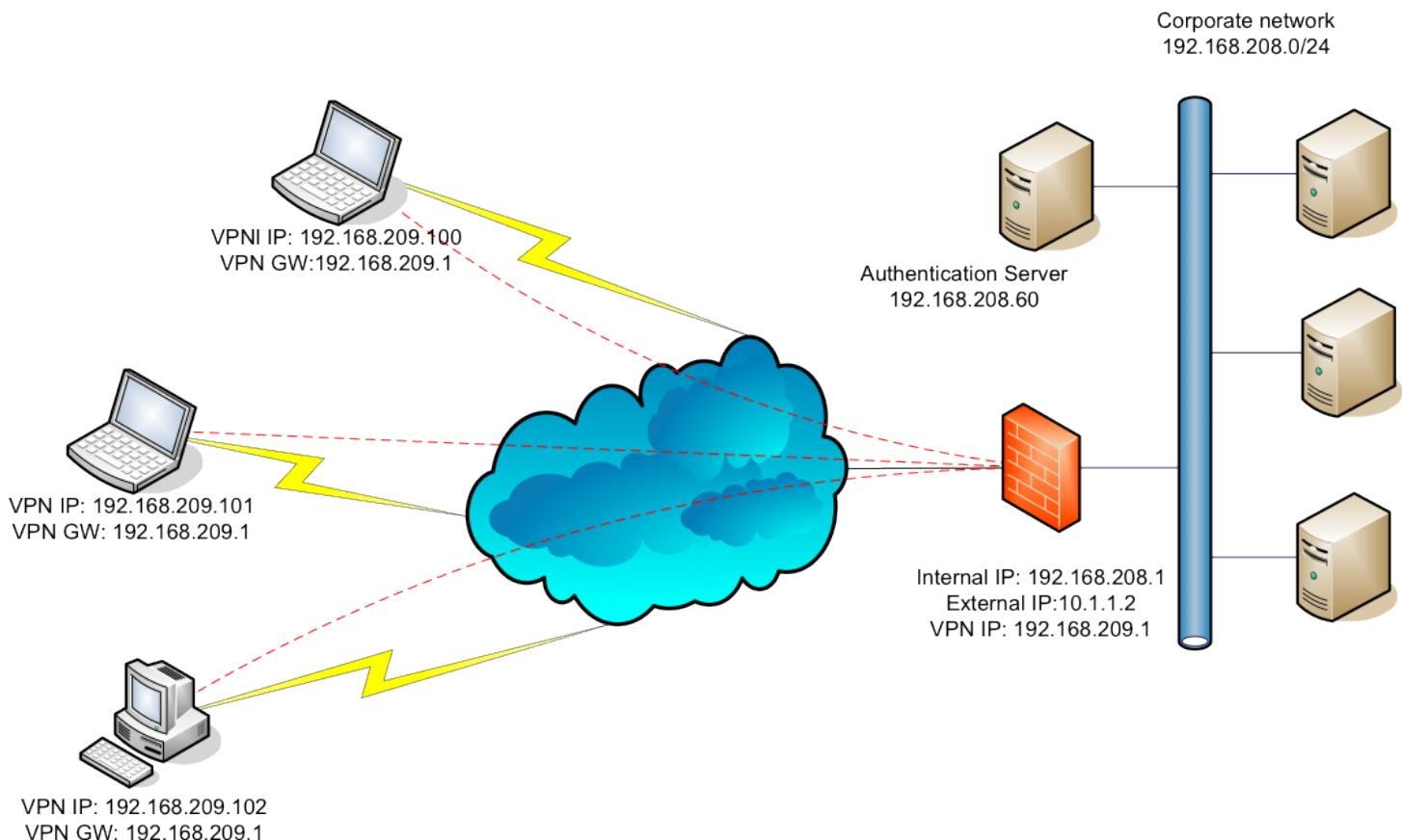
Рисунок 9. Схема подмены IP-адресов при работе межсетевого экрана
